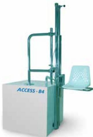
Versatile, si adatta alla maggior parte delle piscine. Realizzato in acciaio inox 316L. Capacità di carico max 120 kg. Angolo di rotazione 150°. Pressione d'azionamento 3,5 - 5 bars. Struttura tubolare esterna diametro 48,3x2 mm. Ancoraggio al suolo. Azionamento dall'interno e dall'esterno della piscina.
